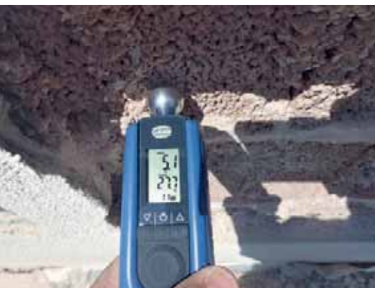
Photo 7: l'hygromètre GANN-Hydromette affichait un taux d'humidité de 4,6 à 5,1% en masse.
