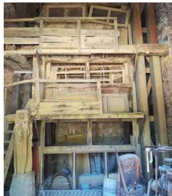
L'ocre était broyée dans le moulin puis passait dans une superposition de cribles..
