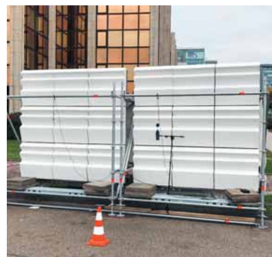
Façade d'essai ETICS en position de montage «Grand élément en bas (GEB)».
