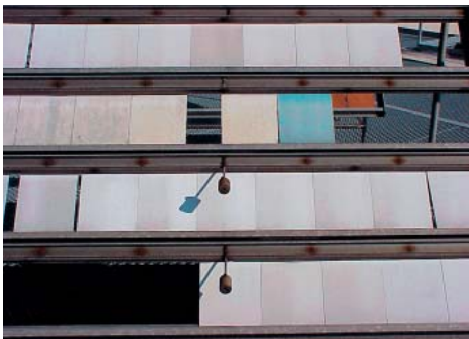
Test di resistenza agli agenti atmosferici delle vernici.
