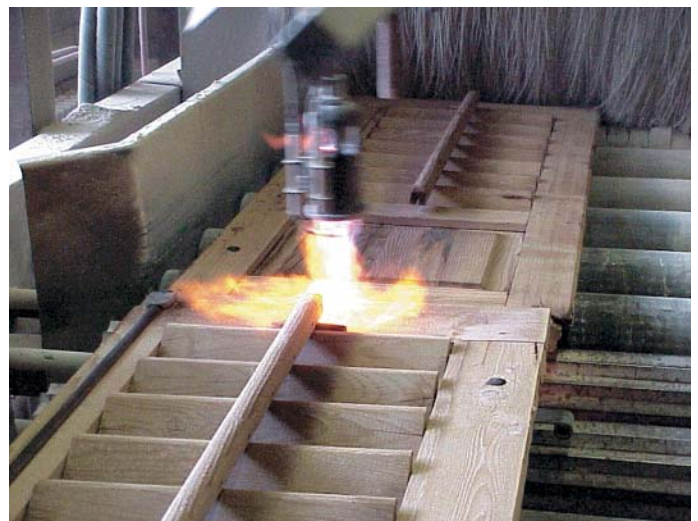
Durch Abflammen und anschließendes Strahlen lassen sich aufstehende Holzfasern entfernen.
