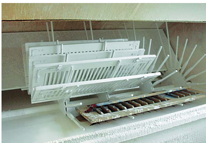
Tauchgrundierung von Holzfensterläden im Trommelverfahren.
