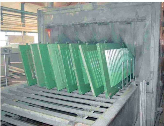
Automatisches Ablaugen von Holzläden in einem 5-Zonen-Ablaugeautomaten.
