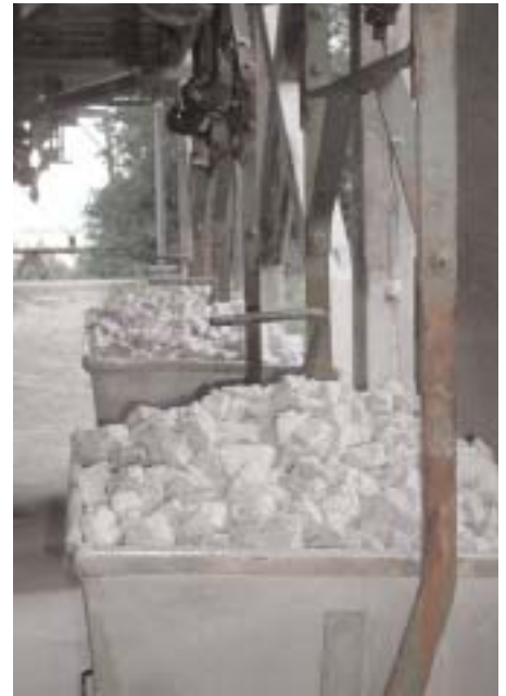
Die gebrochenen Steine der Gipsabbaustelle Melbach werden per Seilbahn zu Tal gebracht.
