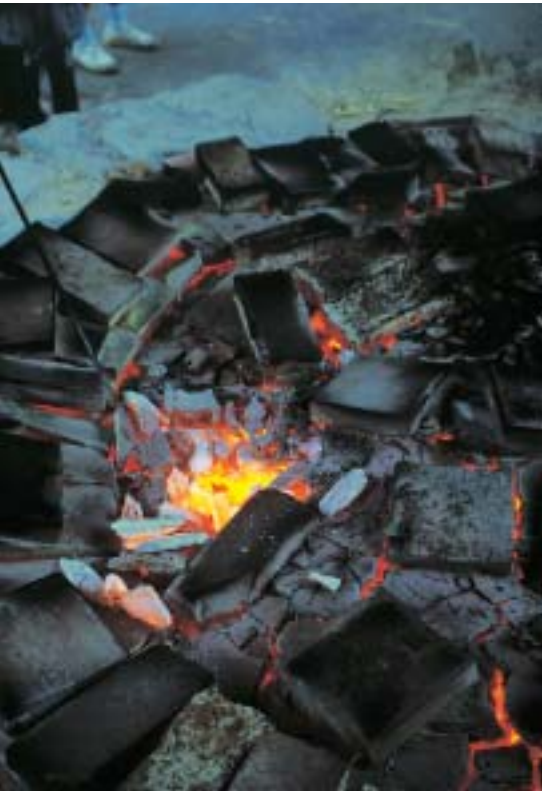
Die Kalksteine glühen. Ein chemischer Prozess setzt ein: Das Kohlendioxid ( \text{CO}_2 ) entweicht. Zurück bleibt Kalziumoxid ( \text{CaO} ).
