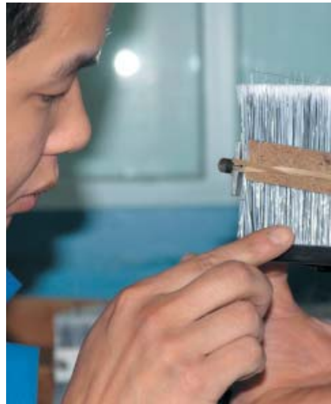
Der Bürstenkopfbesatz wird mit dem Bürstenkörper verleimt.
