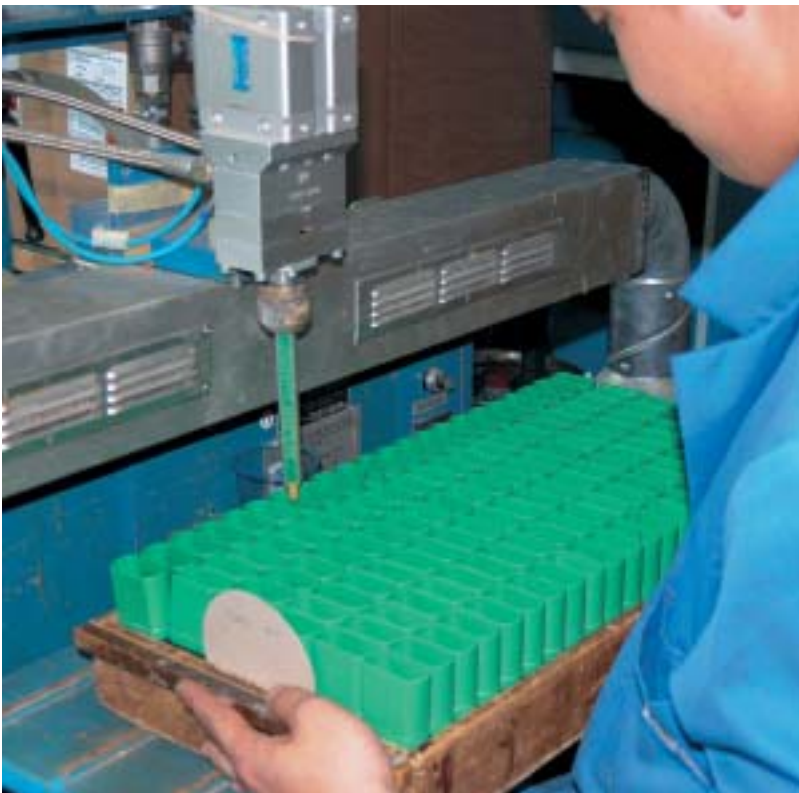
In der Kitterei werden die Pinselköpfe mit einem Zweikomponenten-Klebstoff aufgegossen.
