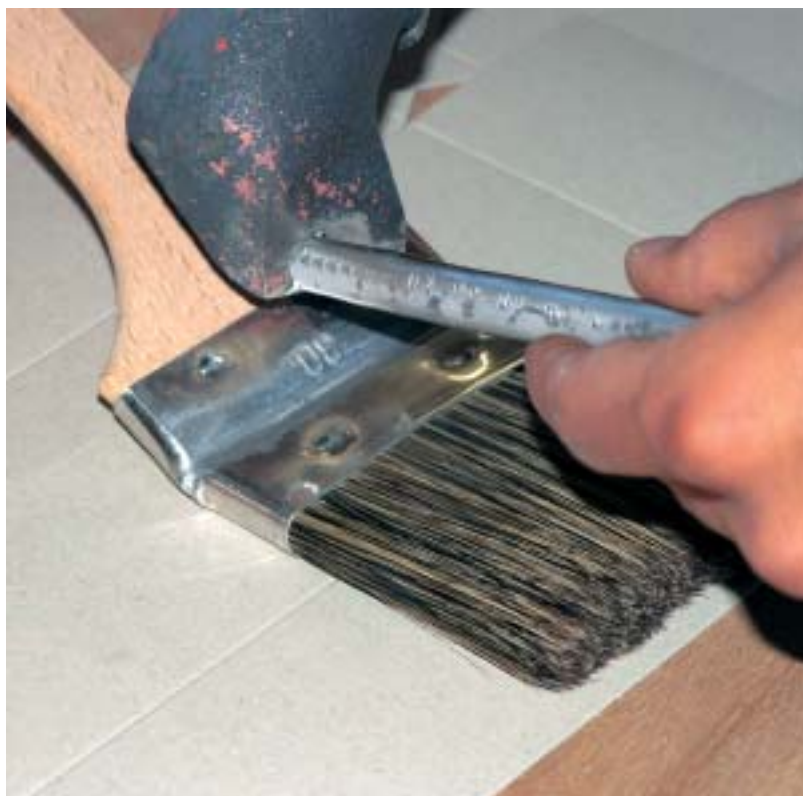
Die Biegestelle einer gekröpften Fassung wird durch Lötten verstärkt.
