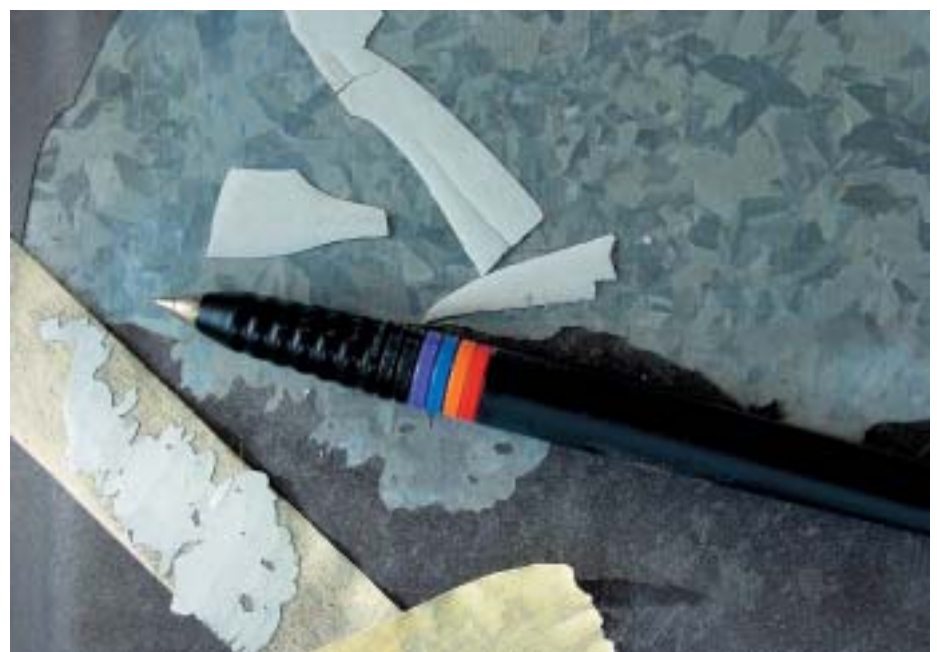
Oxidativ trocknende Anstriche auf Alkydharzbasis eignen sich nicht für verzinkte Untergründe, da sie verspröden.
