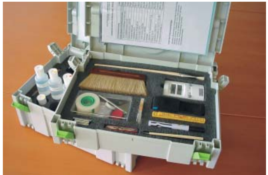
Mit einem Prüfset lässt sich ein Gipsuntergrund oder eine Altbeschichtung einfach auf seine bzw. ihre Tragfähigkeit prüfen.
