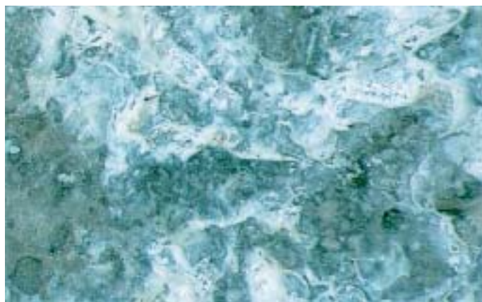
Superfici zincate a caldo con sali di zinco (immagine ingrandita 225 volte): una base inadatta a successive verniciature.
