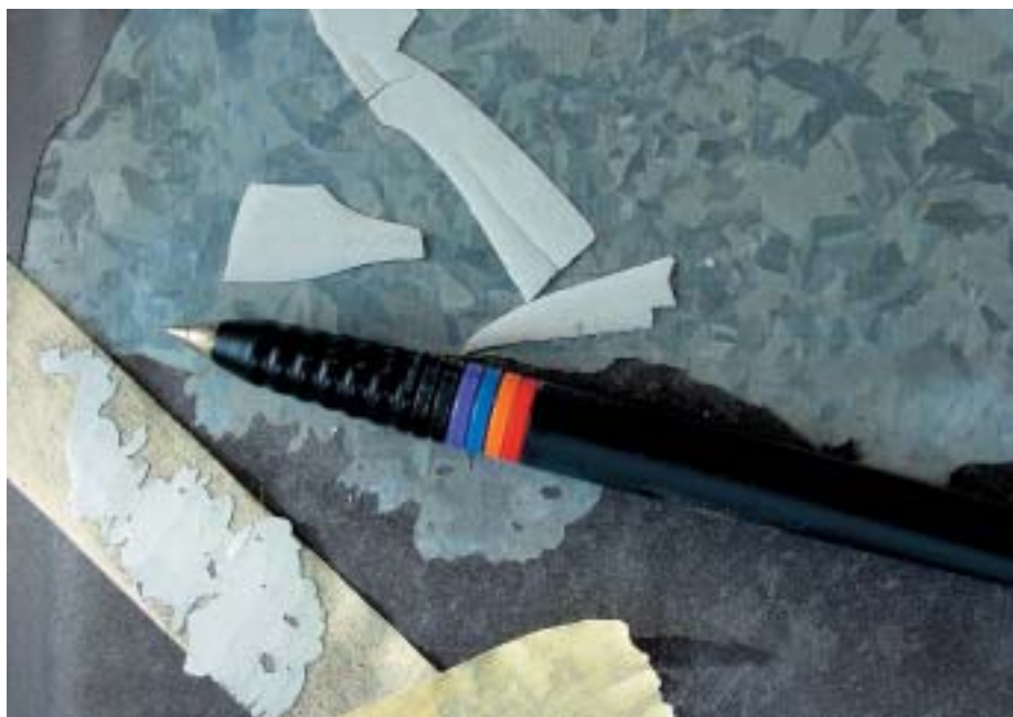
Le vernici a resina alchidica ad essiccamento ossidativo non sono adatte ai fondi zincati perché si infragiliscono.
