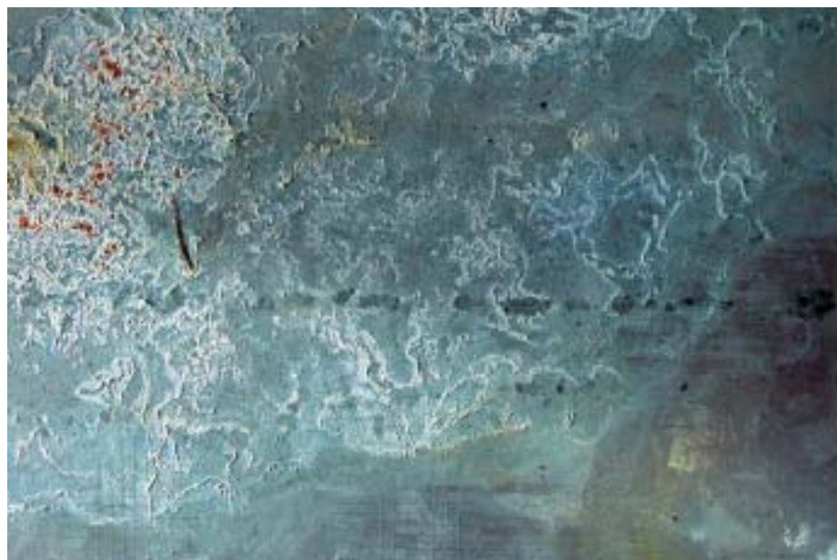
Se il fenomeno della ruggine bianca è contenuto, l'acciaio è tranquillamente utilizzabile. Se però lo si vuole verniciare è necessario asportare la ruggine bianca.
