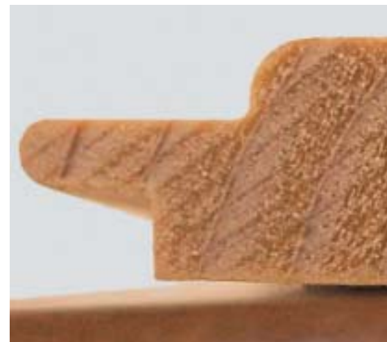
Gerundete Kanten gewährleisten gleichmässige Schichtdicken des Beschichtungsmaterials.
