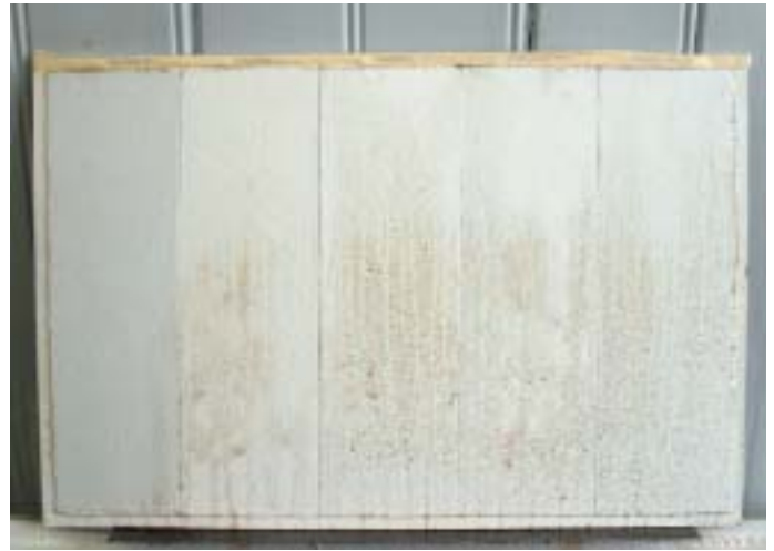
Lässt man nun, der Werbung folgend, den «Regen» die Flächen abwaschen, sieht man deutlich, dass die Regenabläufer auf den hydrophoben Anstrichen wesentlich ausgeprägter und inhomogener sind als auf der hydrophilen Mineralfarbe.
