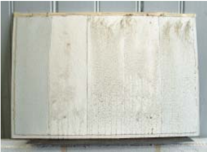
... zeigt sich klar, dass auf den hydrophoben und damit kondensfeuchten Anstrichen der Schmutz stärker anhaftet (analog zum Wiener Schnitzel).
