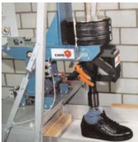
In der Schweiz wird die Gleitfestigkeit im Labor mit einer Messmaschine ermittelt.
