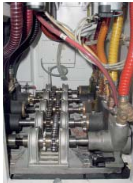
Bei Vollautomaten übernehmen Zahnradpumpen das Dosieren.
