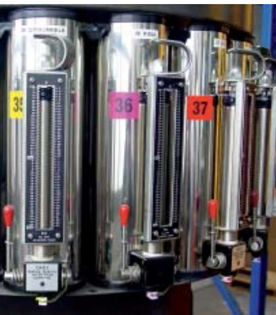
Bei einem manuellen Abtönkarussell wird die Menge der zu dosierenden Abtönpasten von Hand eingestellt. Hier ein Karussell mit 16 Vorratsbehältern.
