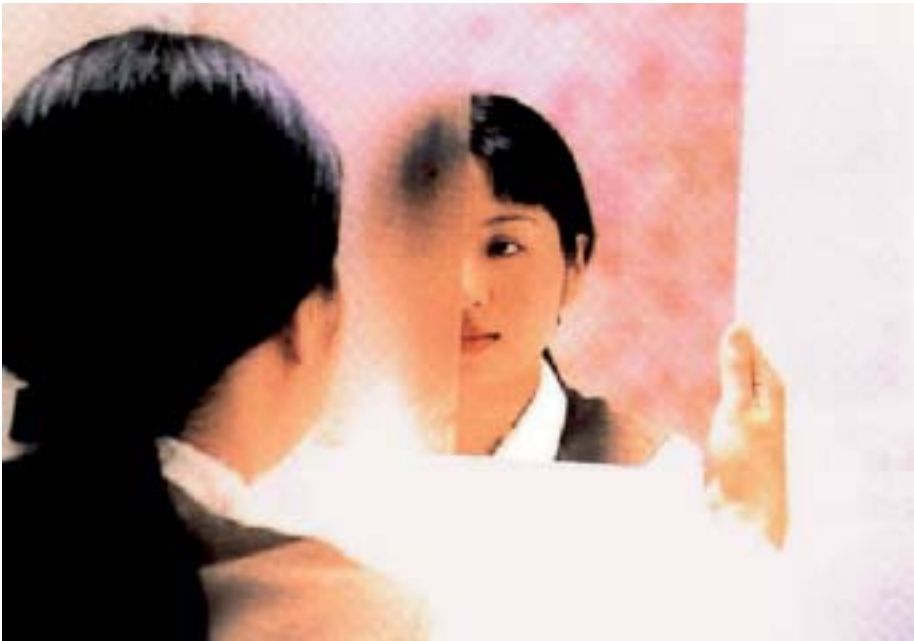
2 Ein mit einer transparenten, nanometerdicken Fotokatalysatorschicht beschichteter Spiegel erhält durch UV(A)-Bestrahlung eine superhydrophile Oberfläche, die sich nicht mehr beschlägt. Die linke Hälfte des Spiegels ist unbeschichtet.
