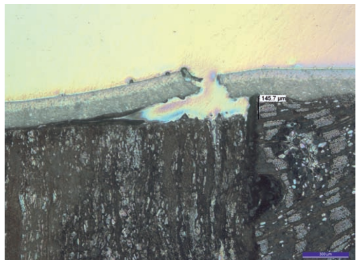
5 Das unterschiedliche Quellverhalten zwischen Spanplatte (links) und Massivholz (rechts) führte zum Abreißen der Beschichtung.
