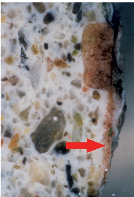
Im Schlifffbild mit 16-facher Vergrösserung sind die Farbreste gut zu erkennen (Pfeil). (Foto: BWS Labor)
