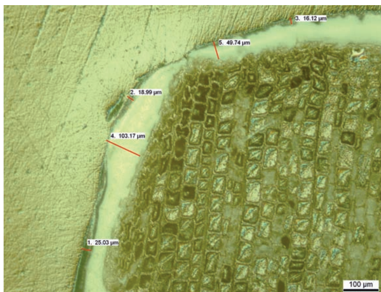
2 Cette microphotographie montre la minceur du revêtement sur le bord.
