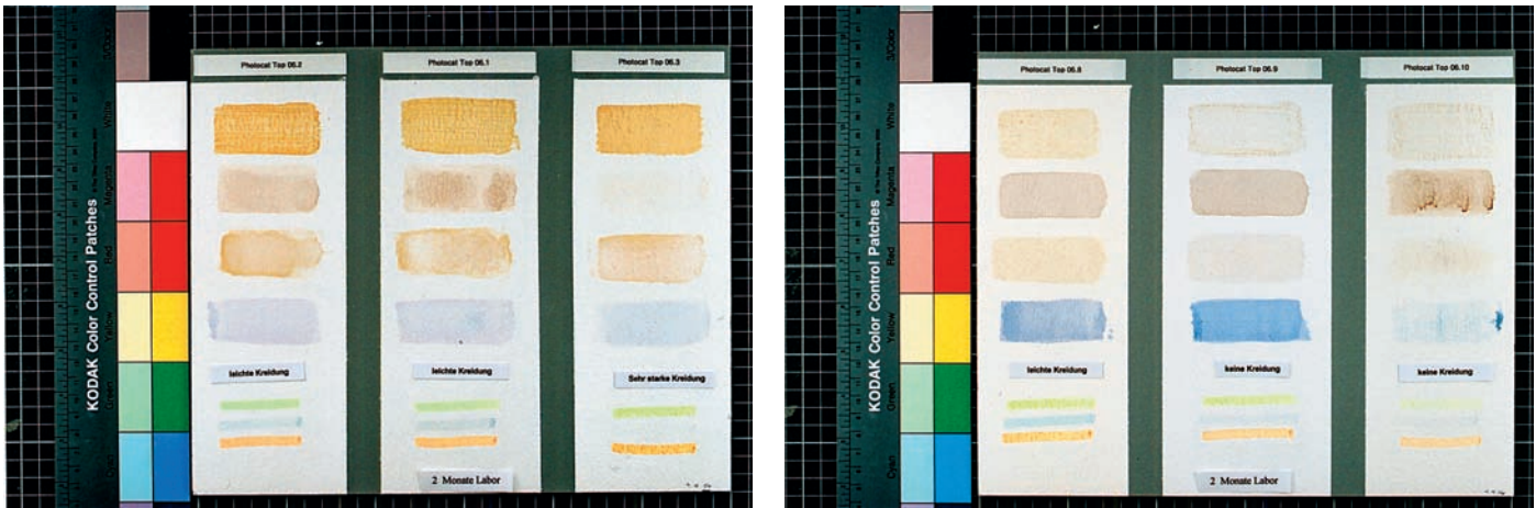
4 Flecken von Ketchup, Kaffee, Traubensaft und Methylenblau (von oben nach unten) auf unterschiedlichen Beschichtungen (links drei Testformulierungen, rechts drei Marktprodukte), nachdem sie in einem Innenraum zwei Monate lang dem Tageslicht ausgesetzt waren. Keiner der Beschichtungen kann eine überzeugende reinigende Wirkung attestiert werden.
