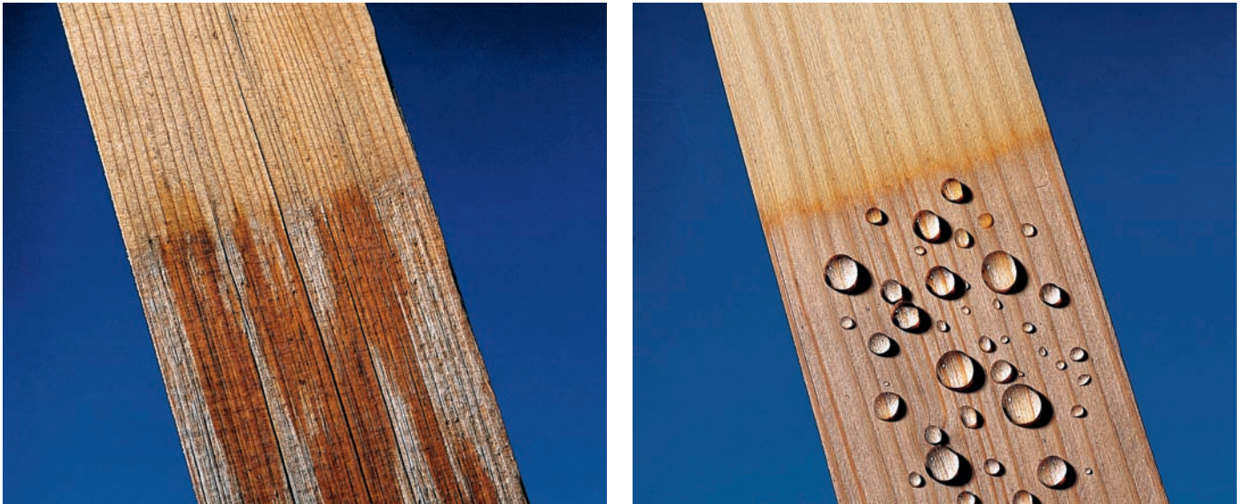
Die Wirkung einer Hydrophobierung nach sechs Monaten Bewitterung: links ohne, rechts mit wasserabweisender Imprägnierung.
