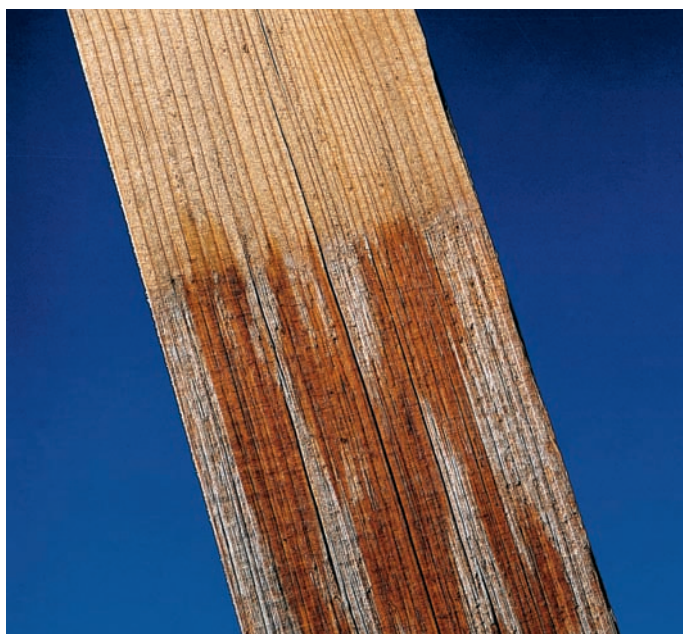
Effetto di un idrofobizzante dopo sei mesi di esposizione alle intemperie: a sinistra senza, a destra con impregnante idrorepellente.
