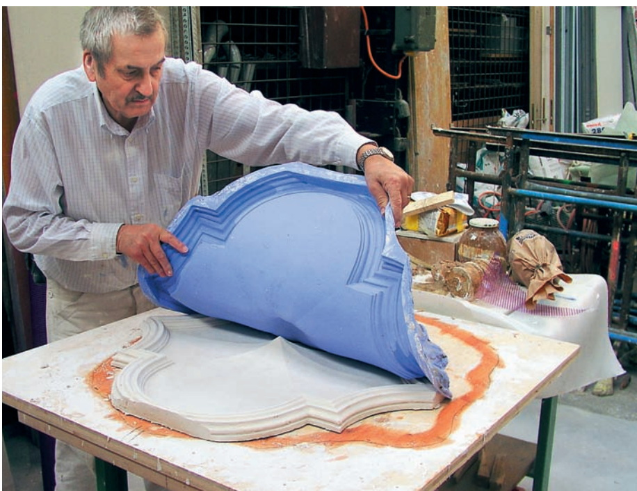
Fast wie am Fließband: Im Atelier der Salvini AG wurden die Duplikate für die Stuckdecke angefertigt.
