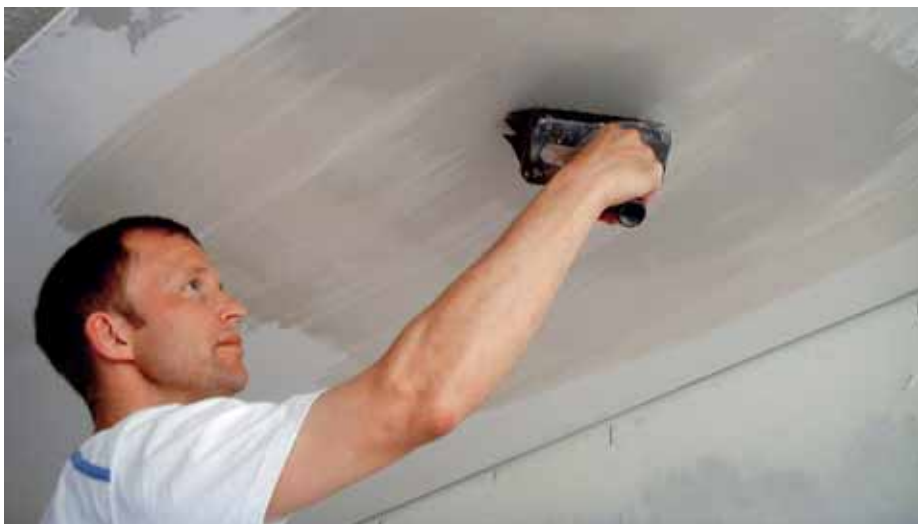
Saugfähigkeitstest: Wird das auf einer Weissputzfläche aufgetragene Wasser gleichmässig aufgenommen? (Foto: SMGV)
