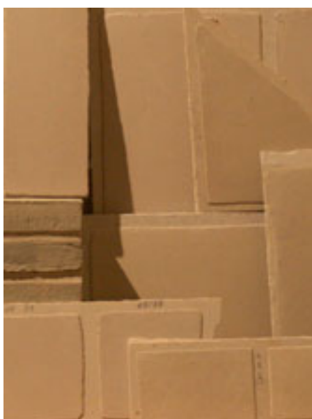
Den langen Weg vom spröden Zementputz zum kolumbagrauen Lehmputz, der mit den Klinkern der Aussenfassade harmoniert, dokumentieren die Putzmuster.
