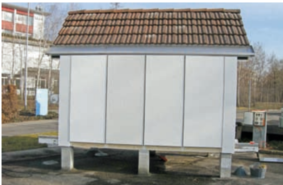
Dieses Modellhaus steht auf dem Empa-Gelände in Dübendorf. Daran sind Fassadenelemente mit ausgewählten Putzen und Farbanstrichen montiert. Eine der Beschichtungen wurde mit nanopartikulärem Silber aufgebaut.
