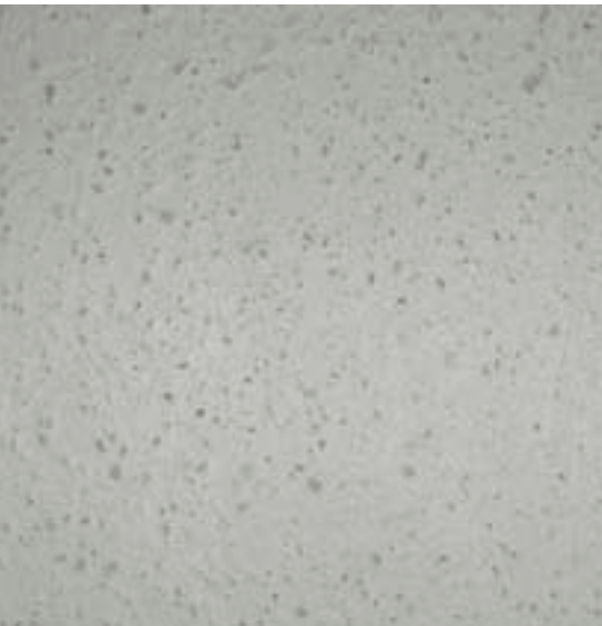
Aus der Ferne betrachtet ist der «reinweisse» Lehmputz angenehm zurückhaltend. Von Nahem zeigt sich seine mineralische Struktur mit glitzerndem Glimmer sowie Zuschlägen zwischen Anthrazit und Ocker und deren Schattenwürfe. (Bild: Lanatherm)
