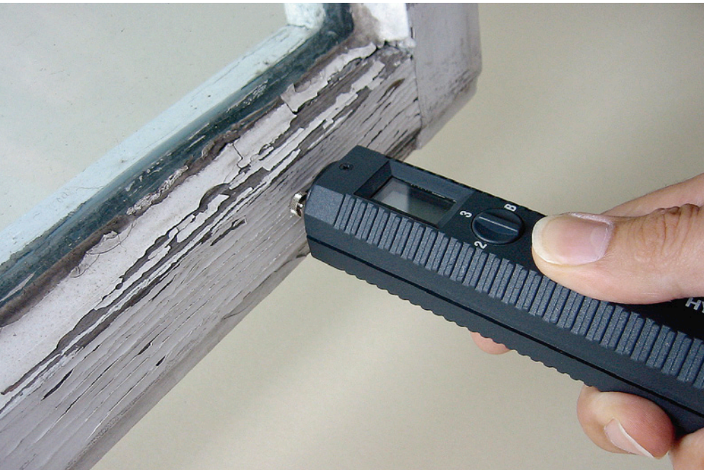
Die Prüfung des Holzuntergrundes seitens des Auftragnehmers dient der Feststellung, ob der Feuchtegehalt nach SIA 257 nicht überschritten wird.
