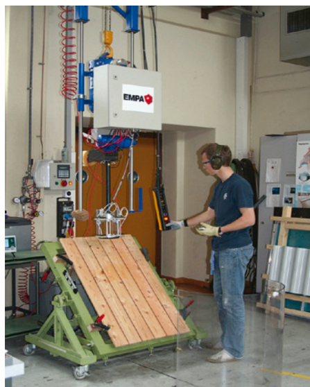
Begutachtung einer Holzverschalung nach dem Beschuss mit Eiskugeln. (Bild: Lignum)
