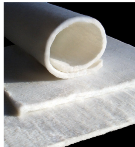
Flexible Vliesmatten müssen gestützt werden, beispielsweise mit einem besonders befestigten Gewebe. (Bild: Stadur)
