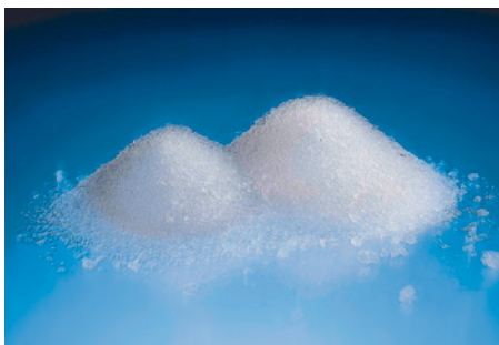
Bis in 5 mm schmale Zwischenräume kann Aerogel rieseln. (Bild: Cabot Corp.)
