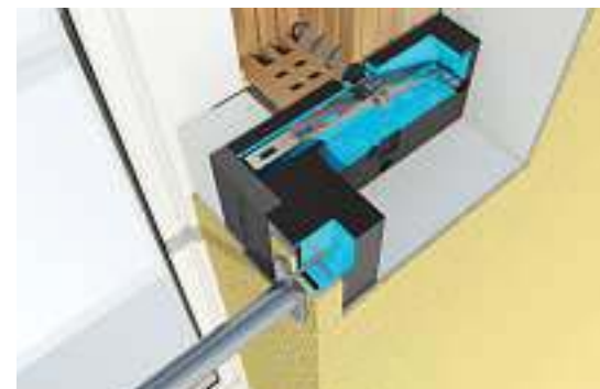
Schematische Darstellung der korrekten Montage eines französischen Geländers mit aufgeschnittenem Tragwinkel.
