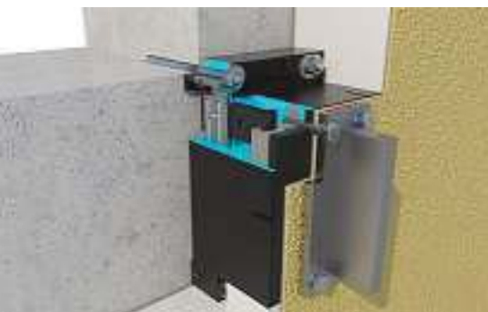
Korrekte Montage der Konsole eines Vordachs mit aufgeschnittener Schwerlastkonsole. Schematische Darstellung.
