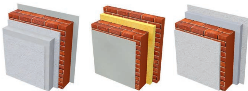
Aussendämmung, Kerndämmung, Innendämmung (von links nach rechts).
