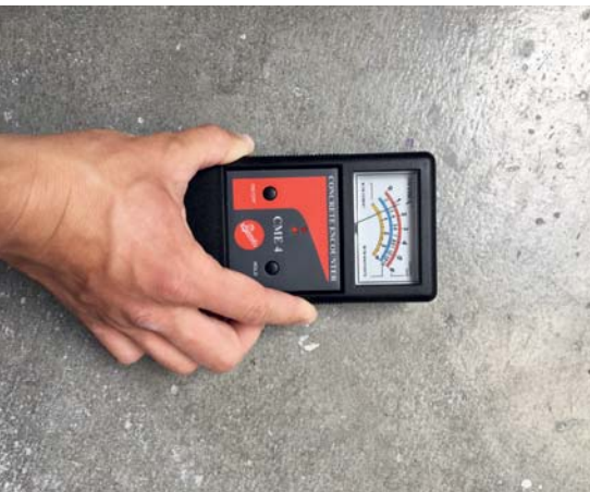
Messung der Untergrundfeuchtigkeit.
