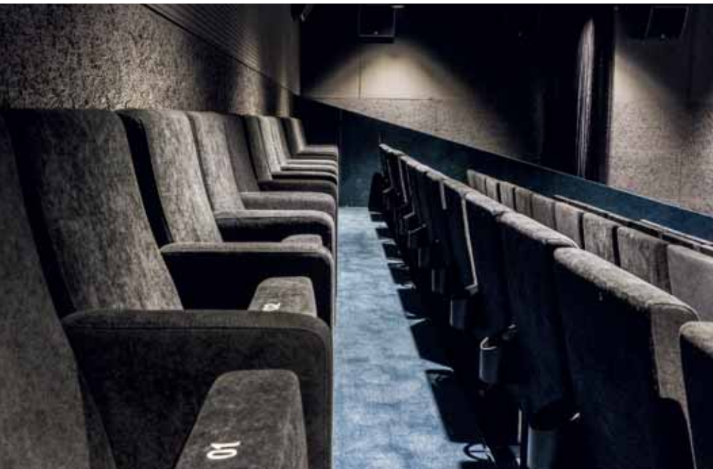
Das Kino im Kulturplatz Davos GR: Bei Räumen mit hohen Ansprüchen an die Raumakustik und der Notwendigkeit für sehr tiefe Nachhallzeiten sind schallabsorbierende Oberflächen mit diversen Eigenschaften und für unterschiedliche Frequenzbereiche nötig. (Bilder: Thomas Kuster)
