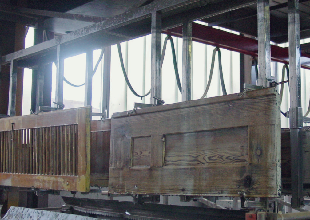
Fensterläden im computergesteuerten Ablaugeautomaten. (Bild: ABL Schweiz)
