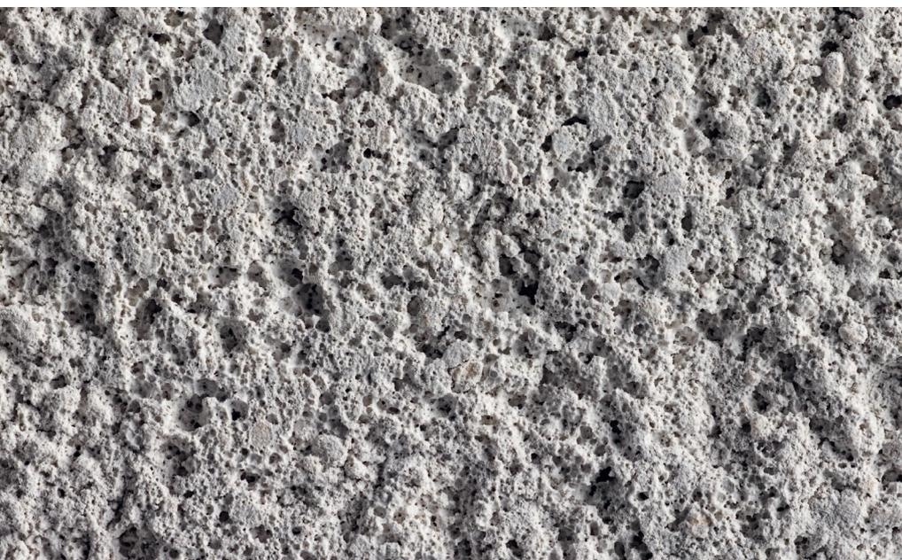
Leichtputz mit hoch wärmedämmenden Eigenschaften für alle gängigen Mauerwerksarten und Altputzflächen: Tri-O-Therm M.
