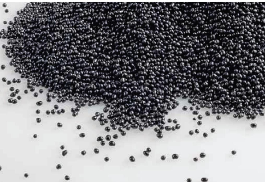
EPS-Dämmstoffe werden aus Granulat hergestellt.
